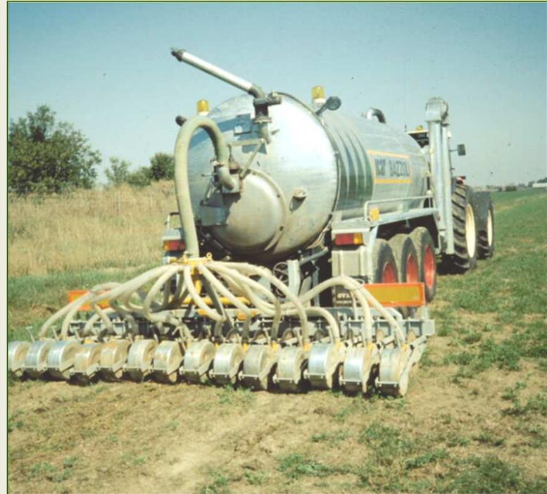
L'erogazione con dispositivi ad alta pressione (8-9 atm) determina la polverizzazione del getto con formazione di odori, perdite di ammoniacale, formazione di aerosol.
