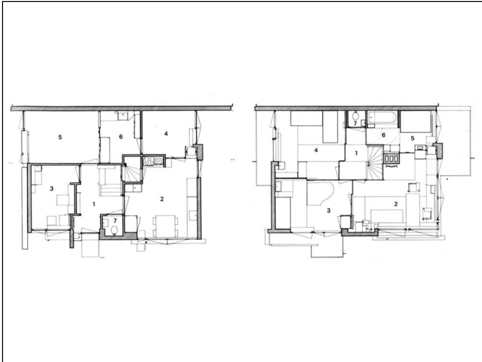
G. Rietveld, Casa Schröder, Utrecht (1923-24): piante del piano terra (a sinistra) e del primo piano (a destra)
