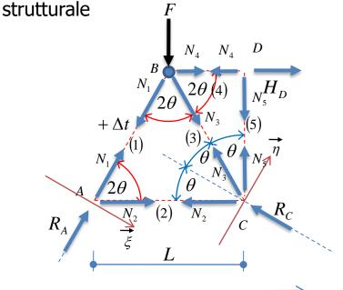
$$\underline{R} = \begin{bmatrix} R_A \\ R_C \\ H_D \end{bmatrix} = \begin{bmatrix} 2\sqrt{3}/3 \\ 0 \\ -\sqrt{3}/3 \end{bmatrix} F \cong \begin{bmatrix} 1.155 \\ 0 \\ -0.577 \end{bmatrix} kN$$
