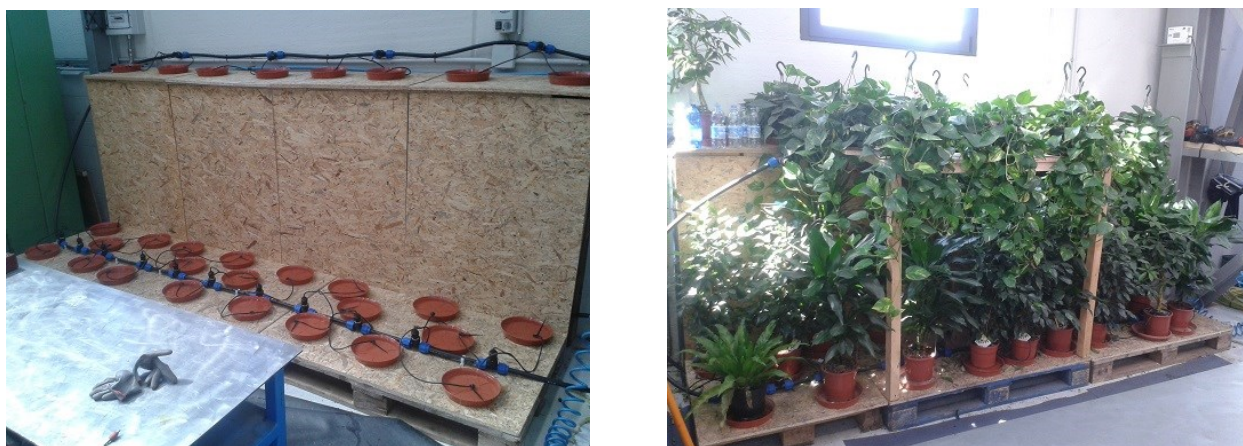
Figura 4 – Struttura di alloggiamento ("cubo") delle piante utilizzate per il progetto sperimentale di fitodepurazione
