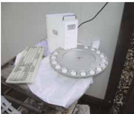
Figura 16: Strumentazione per il calcolo dell'indice di annerimento
