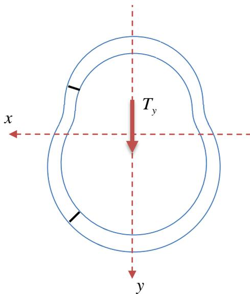
Per la sezione in esame si potrebbero considerare ad esempio le corde indicate in figura. In questo caso però la formula di Jourawsky permetterebbe di calcolare solo il valore medio delle tensioni tangenziali presenti in tutte e due le corde, senza poter distinguere la tensione tangenziale media presente su una delle due corde da quella presente sull'altra. La soluzione sarebbe allora troppo poco accurata.
