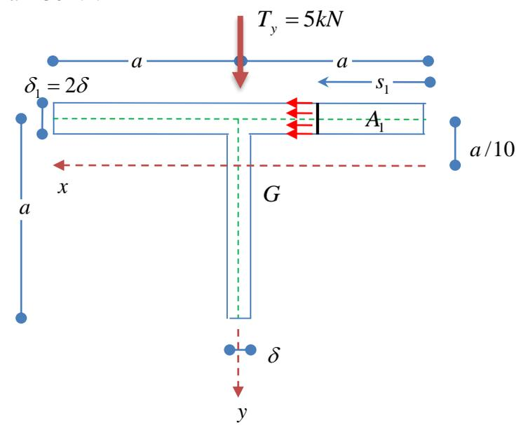
Si osservi che nella (102) il coefficiente  $0.9804$  è espresso in  $N/mm^3$  e quindi, esprimendo  $s_1$  in millimetri si ottengono valori della tensione in MPa.
