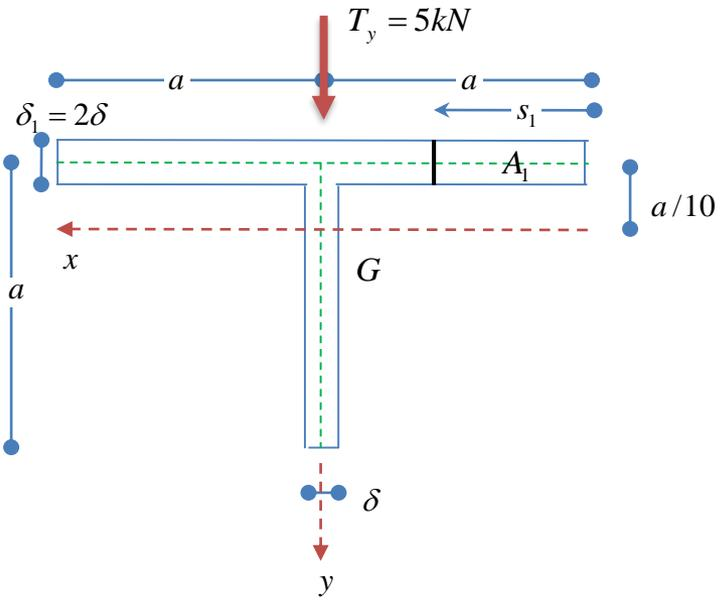
Nel calcolo del momento d'inerzia effettuato nella precedente slide è stato trascurato il termine in  $\delta^3$  in quanto, per definizione, nelle sezioni in parete sottile lo spessore è molto più piccolo delle altre dimensioni.
