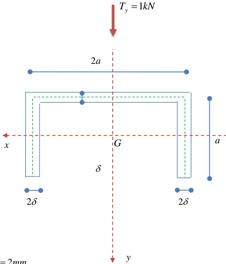
Si calcoli e si diagrammi il valore delle tensioni tangenziali medie per la sezione indicata in figura.
