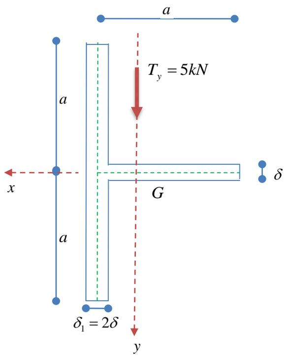
Si calcoli e si diagrammi il valore delle tensioni tangenziali medie per la sezione indicata in figura.
