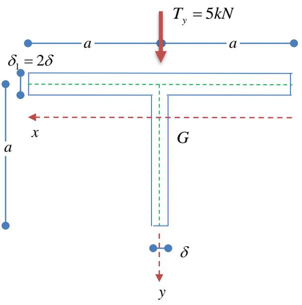
La prima cosa da fare, per poter applicare le relazioni determinate nella precedente lezione, è calcolare il baricentro della sezione (al fine di poter posizionare gli assi del sistema di riferimento). Visto che l'asse  $y$  è asse di simmetria, esso conterrà il baricentro.
