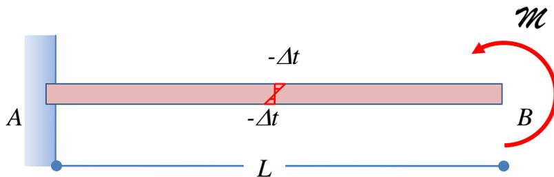
Si determini il valore della variazione termica  $\Delta t$  tale che l'asse della trave schematizzata in figura si mantenga rettilineo.
