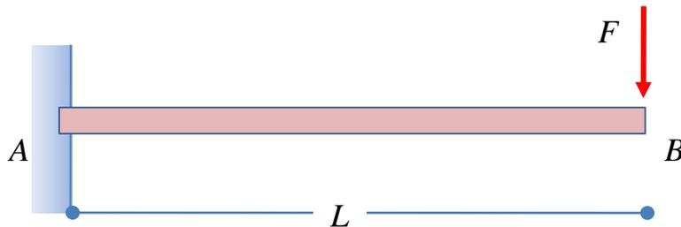
Utilizzando i metodi dell'integrazione della linea elastica del secondo e del quarto ordine, per la struttura schematizzata in figura si calcolino:
