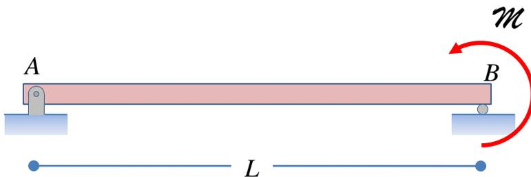
Utilizzando il metodo dell'integrazione della linea elastica del secondo e del quarto ordine, per la struttura schematizzata in figura si calcolino:
