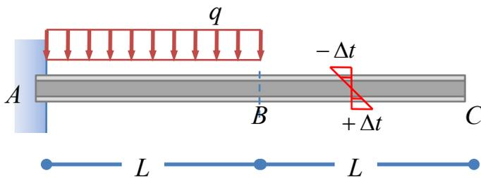
La trave schematizzata a fianco ha sezione trasversale costante. Utilizzando il metodo dell'integrazione della linea elastica del quarto ordine ed il metodo della sovrapposizione degli effetti si calcoli lo spostamento verticale e la rotazione delle sezioni  $B$  e  $C$  indicate in figura.
