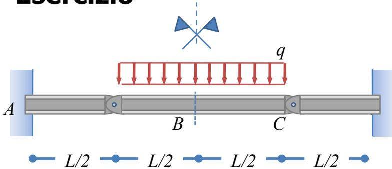
La trave in acciaio schematizzata a fianco ha sezione trasversale costante. Utilizzando il metodo dell'integrazione della linea elastica del secondo ordine ed il metodo della sovrapposizione degli effetti si calcoli lo spostamento verticale delle sezioni  $B$  e  $C$  indicate in figura.
