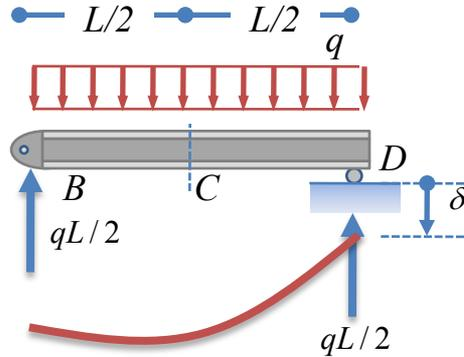
Le componenti di spostamento richieste nel presente esercizio possono essere facilmente determinate utilizzando il metodo della sovrapposizione degli effetti. Le reazioni del vincolo interno sono quelle indicate in figura. È evidente che il tratto *AB* è equivalente ad una mensola caricata da una forza verticale  $P = F + qL/2$  e da una distorsione termica a farfalla. Utilizzando i risultati sintetizzati nella sessione teorica della presente lezione si calcola
