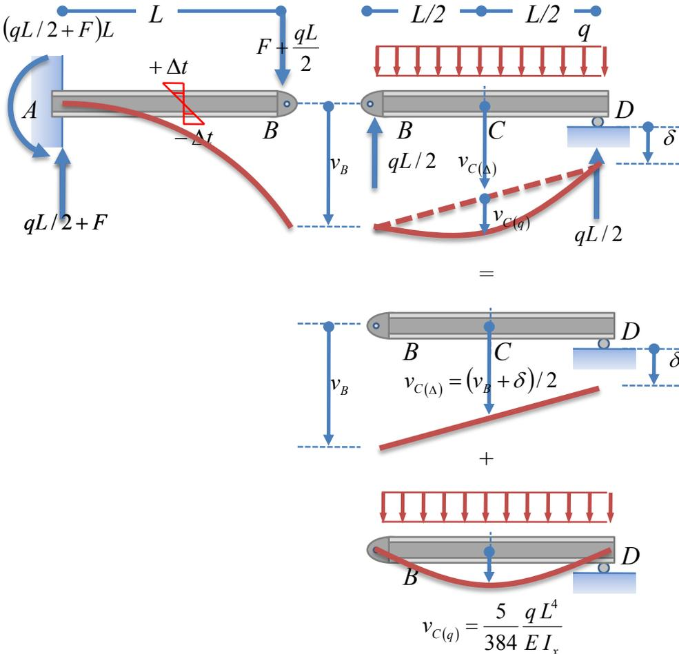
Analogamente, lo spostamento verticale del nodo  $C$  può essere calcolato sommando gli effetti dei cedimenti degli estremi ( $v_{C(\Delta)}$ ) e del carico distribuito  $v_{C(q)}$
