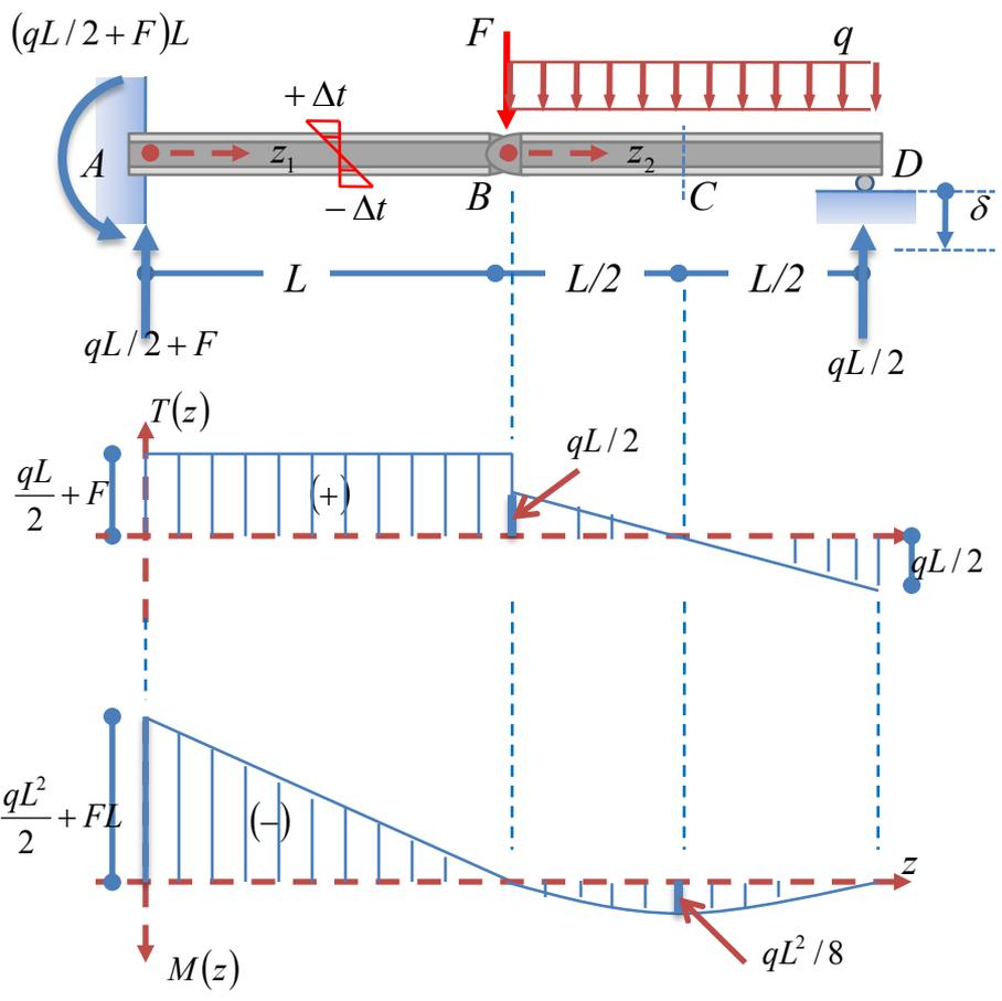
Procediamo adesso con il metodo dell'integrazione della linea elastica del secondo ordine. Le reazioni vincolari, le leggi ed i diagrammi delle caratteristiche della sollecitazione sono quelli indicati in figura e di seguito.
