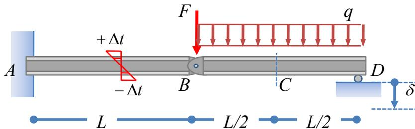
Per la struttura schematizzata in figura si calcoli lo spostamento verticale delle sezioni  $B$ ,  $C$  e  $D$  utilizzando
