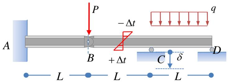
La trave in acciaio schematizzata in figura ha sezione trasversale IPE 140 ( $E=210GPa, I_x=541,0cm^4, \alpha=11.7 \times 10^{-6}C^{-1}$ ). Si risolve la struttura e si verifichi che la massima tensione normale dovuta alla flessione sia inferiore a  $160 MPa$ .
