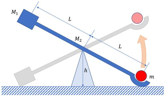
La catapulta può ruotare dalla posizione in cui il contrappeso tocca il suolo, a quella simmetrica. La catapulta viene caricata con un proiettile puntiforme di massa  $m = 4$  kg posizionato all'altro estremo dell'asta rispetto al contrappeso, e viene portata nella posizione in cui il proiettile tocca il suolo. Quindi la catapulta viene lasciata libera di ruotare, fino alla posizione simmetrica, dopodiché il proiettile lascia il supporto.
