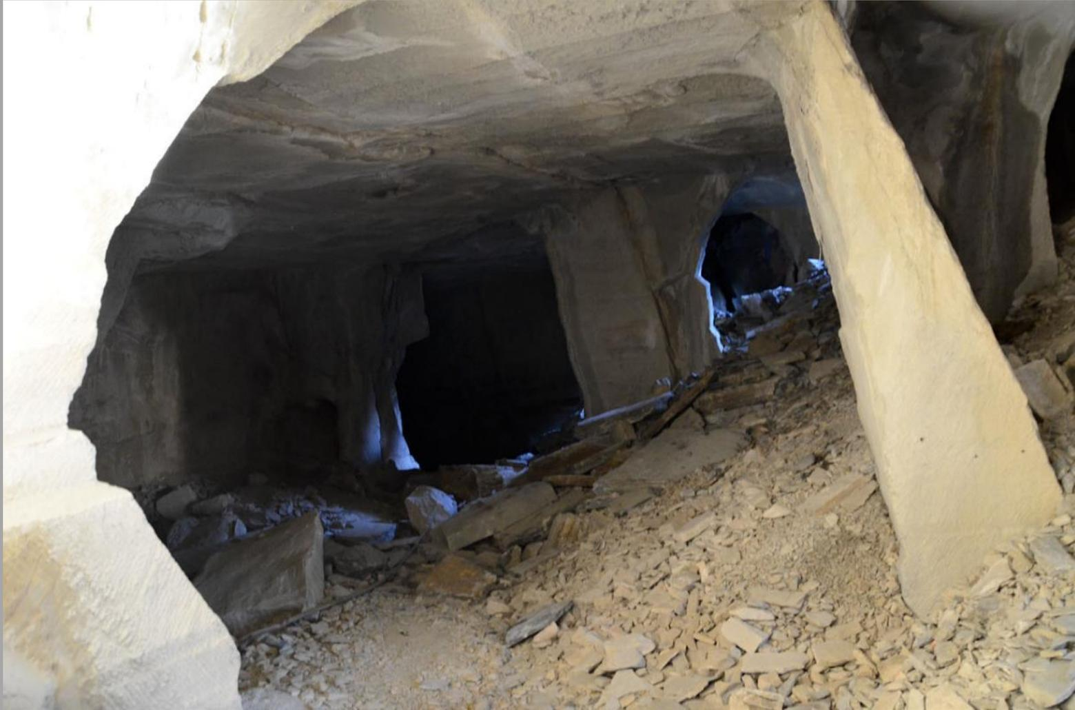
A causa della conformazione geologica di questi giacimenti, che hanno le parti più consistenti in profondità, fu necessario scavare delle vere e proprie gallerie nelle parti più profonde della montagna. Per sorreggere la volta, veri e propri pilastri furono lasciati durante l'escavazione.
