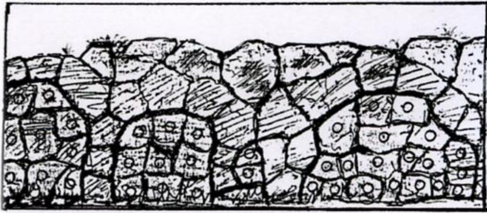
Tecniche costruttive a secco, nel tipo etrusco arcaico e tardo arcaico (VI-IV sec. a.C.)
