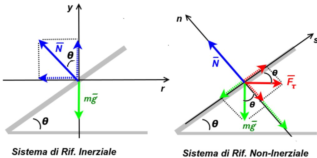
**Figura III.14:** Diagrammi di corpo libero per l'auto in curva sopraelevata (senza attrito).
