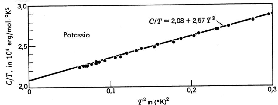
**Figura 8** Valori sperimentali della capacità termica per il potassio, riportati come  $C/T$  in funzione di  $T^2$ . I punti sono stati determinati con un criostato a smagnetizzazione adiabatica [Da W. H. Lien e N. E. Phillips, Phys. Rev. **133**, A1370 (1964)].
