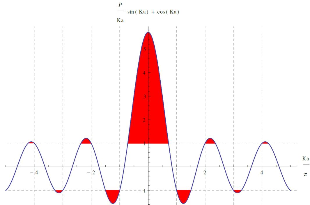
Risolviendo l'equazione per  $k$  vettore di Bloch ( non  $K$  ! ) otteniamo la dipendenza dell'energia con la conseguente formazione delle bande proibite, per  $k = \pi/a n$  dovute alle regioni dove  $f(Ka) > 1$  e  $f(Ka) < -1$ .
