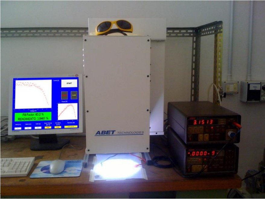
Spectra Xe source and Sun Simulator con filtri AM0/AM1.5G
