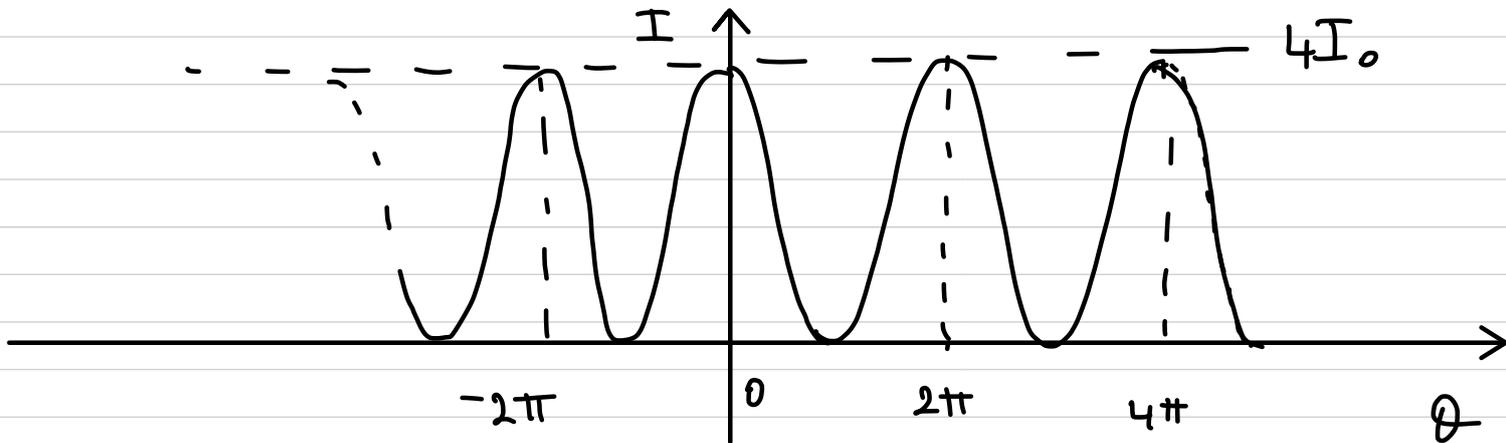
Si ottengono delle **FRANGE DI INTERFERENZA**
