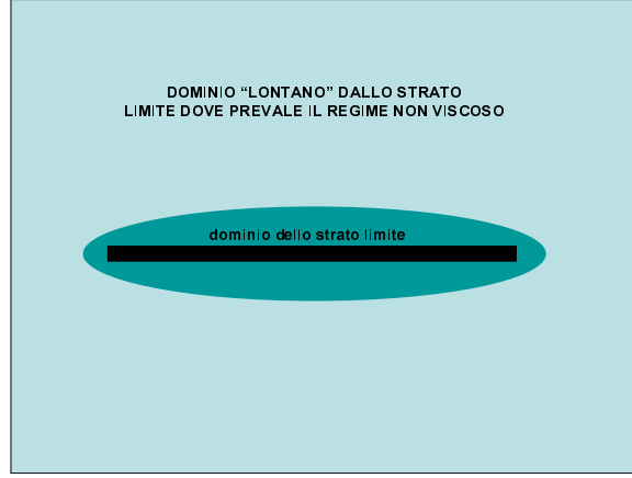
Figura 11.2. Rappresentazione schematica dei domini di validità degli “scalings” proposti. Lo “scaling” (11.8), (11.9), (11.11) sarà corretto solo nel dominio dello strato limite, mentre lo “scaling” (11.13) sarà valido nel dominio lontano. Le dimensioni dei domini non sono in scala.
