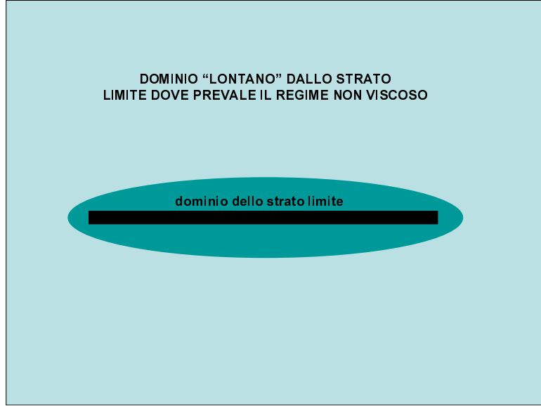
Figure 2: Rappresentazione schematica dei domini di validità degli “scalings” proposti. Lo “scaling” (10), (11), (13) sarà corretto solo nel dominio dello strato limite, mentre lo “scaling” (15) sarà valido nel dominio lontano. Le dimensioni dei domini non sono in scala.
