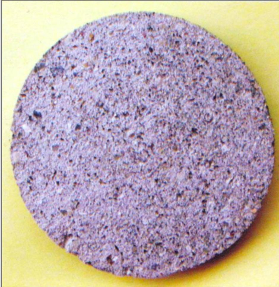
Malta a base di calce idraulica
