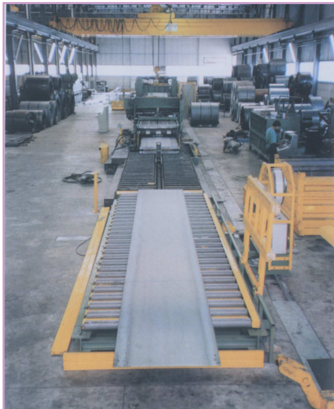
Una delle nostre spianatrici con pesatura automatica
