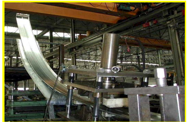
Profilo EP005 centinato in lunghezza e piegato alle due stremità
