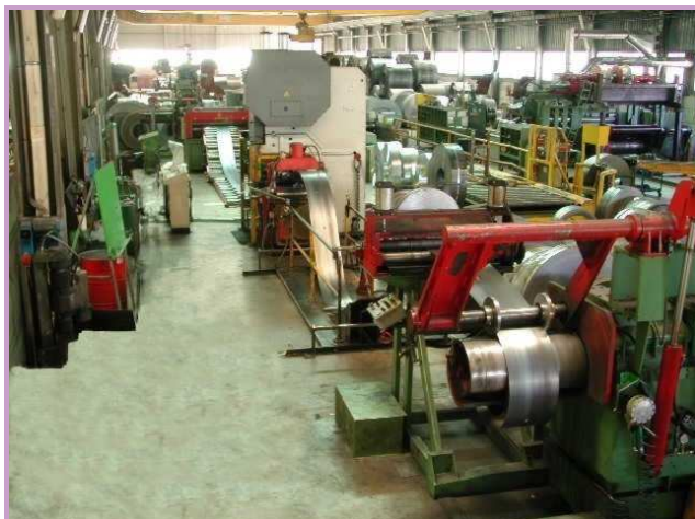
Una delle nostre linee automatiche per foratura nastri
