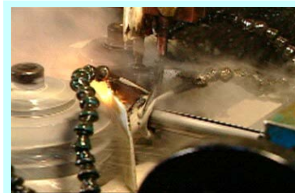
Profili saldati ad induzione con tecnologia H.F.
