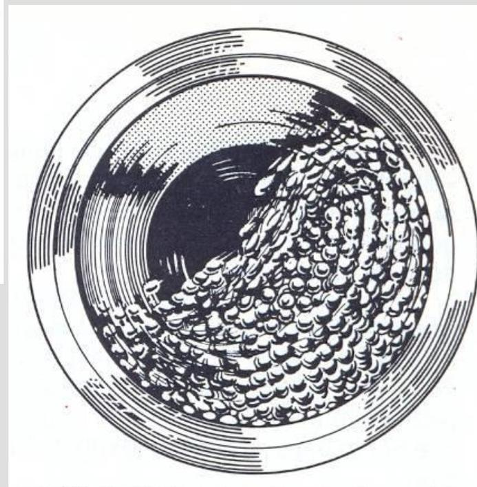
Sezione trasversale forno rotativo.
