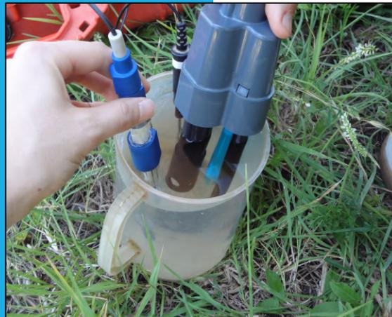
pH-metro e sonda multiparametrica per la misurazione dei parametri chimico-fisici delle acque.
