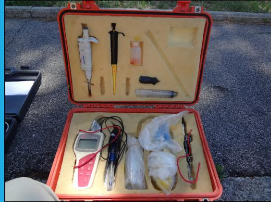
Microdosimetro (a) e valigetta contenente la strumentazione per le misure di alcalinit  (b).
