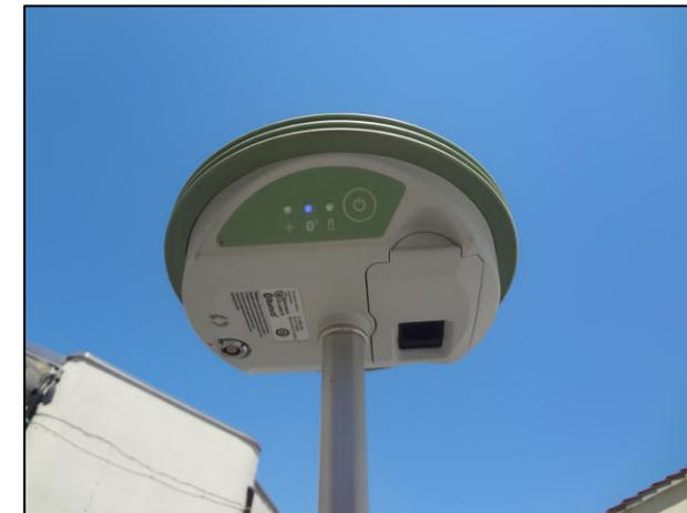
Figura 14. GPS differenziale per misure di precisione.
