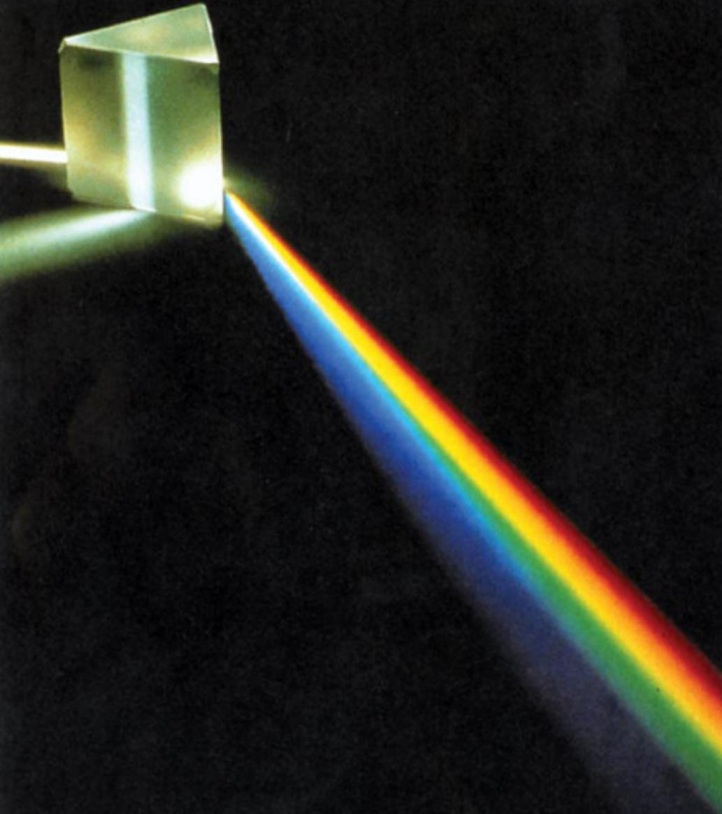
Newton fu il primo a scoprire (1672) che la luce del sole conteneva tutti i colori: proiettando la luce solare su di uno schermo mediante un prisma appariva il classico arcobaleno, che è uno spettro della radiazione solare.
