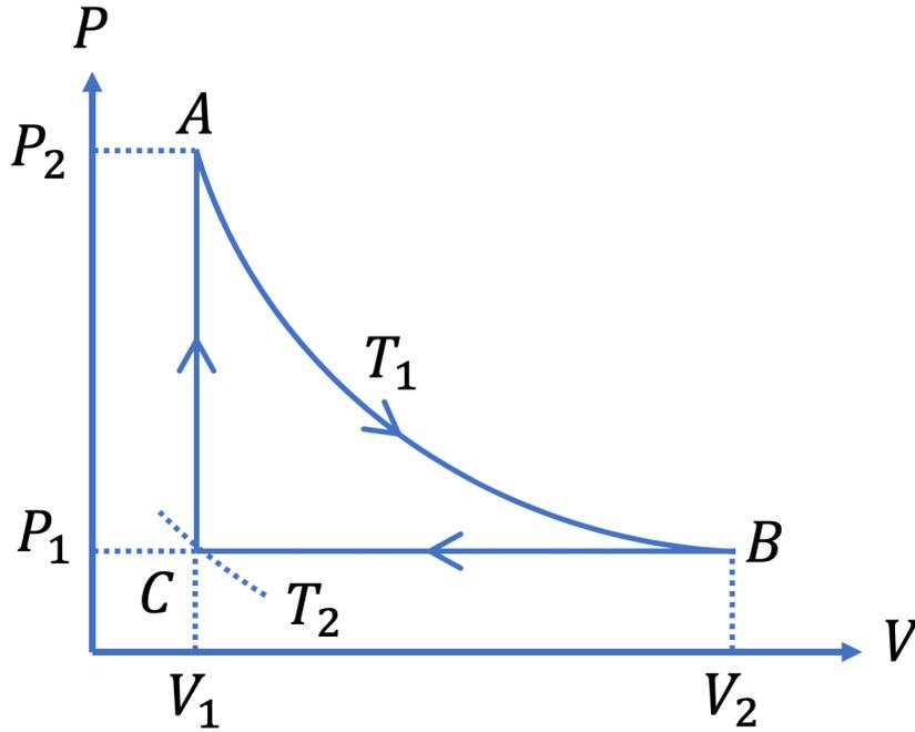
Figura 1: Ciclo termodinamico composto da una isoterma ( $AB$ ), una isobara  $BC$  e una isocora  $CA$ .
