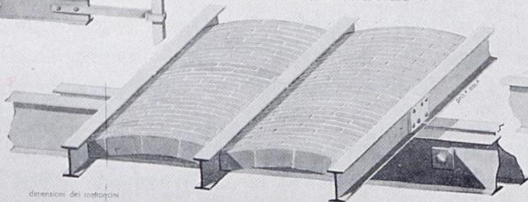
Fig. 4 - Un tipo di impalcatura in ferro a trave maestra con volte di una testa, costruite senza armatura.
