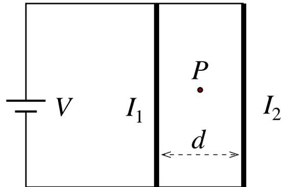
Un circuito elettrico è formato da un generatore di tensione  $V = 55 \text{ V}$ , da due fili rettilinei e paralleli posti verticalmente ad una distanza  $d = 0,15 \text{ m}$  e lunghi ciascuno  $l = 1,20 \text{ m}$ , oltre ai fili di collegamento di resistenza trascurabile, come in figura.
