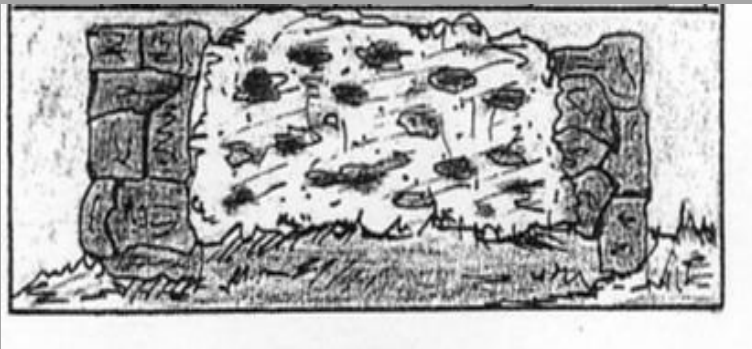
Muratura propriamente a sacco con malta
