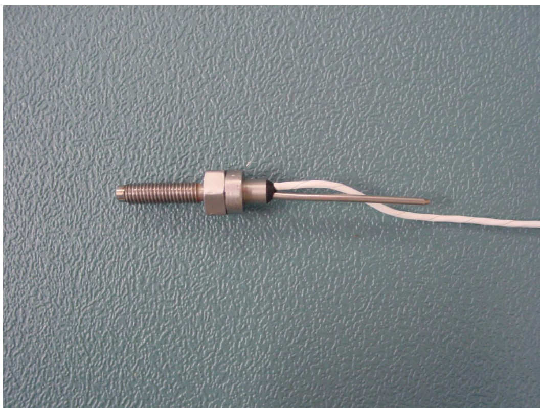
Figura 25. Una Kulite serie XTE-190-200-D utilizzata per le prove
