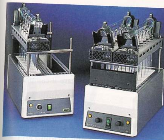
FIGURA 14.20 Unità di mineralizzazione.
