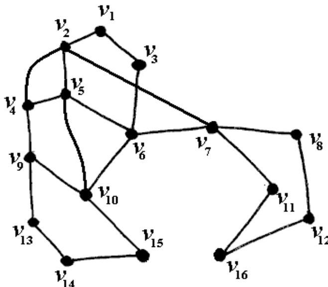
potete dunque dire subito che **non è hamiltoniano**, perché **non è 2 – connesso!** (Sopprimendo il vertice  $v_7$  e i quattro lati ad esso incidenti si ottiene un grafo non connesso).
