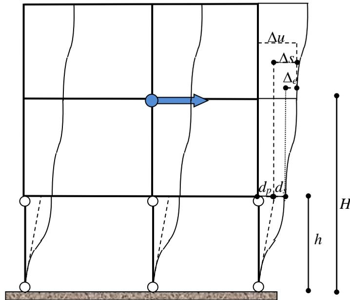
Figura 14 – Stato deformativo al collasso di un edificio dotato di piano sofficcio
