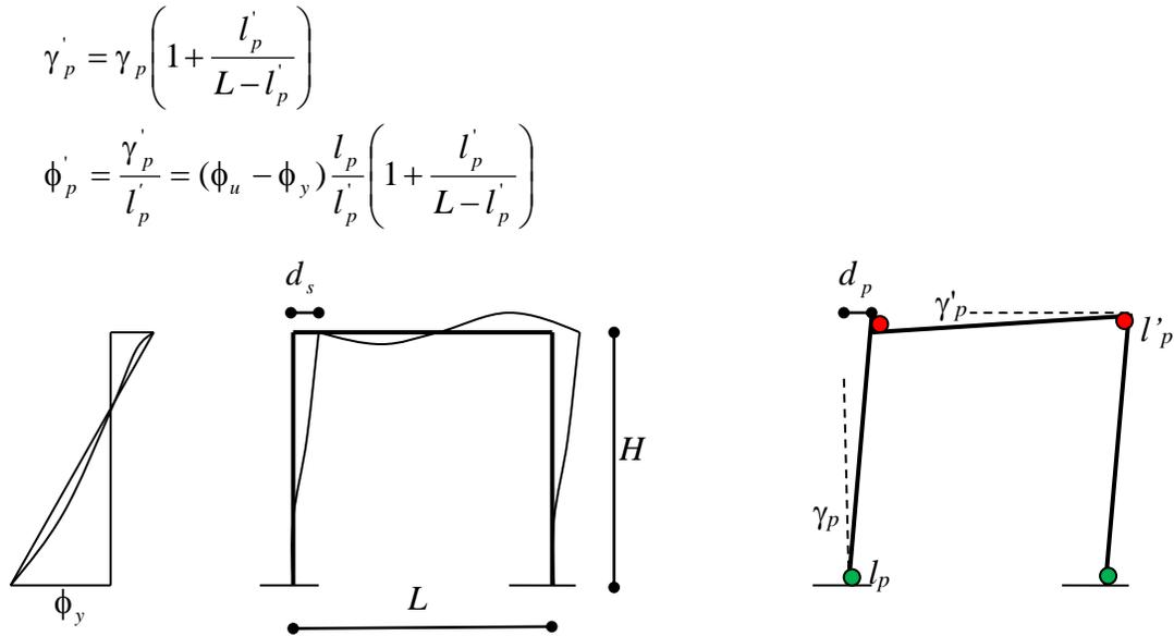
Figura 13 –Schema di rappresentazione di un portale, in campo elastico ed in fase di cinematiso plastico
