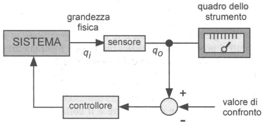
Schema di sistema di controllo ad anello chiuso.
