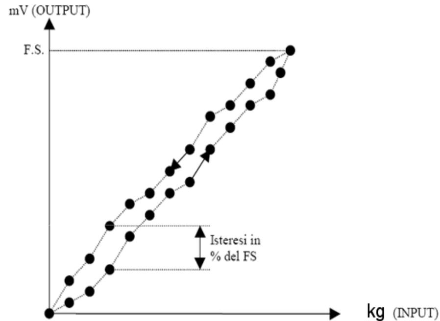
Fornisce una indicazione dell'attitudine di un trasduttore a produrre la stessa uscita sia nel caso che l'ingresso di riferimento sia raggiunto da valori inferiori sia che venga raggiunto da valori superiori.
