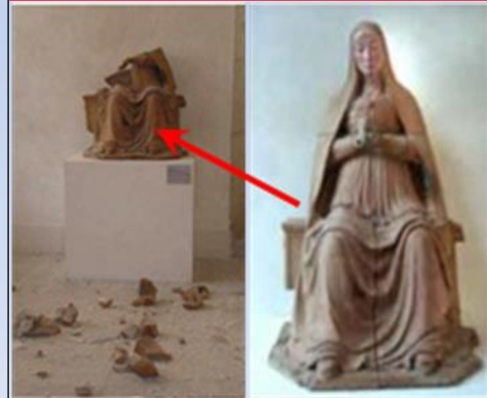
Modalità di collasso fragile di statue massicce
