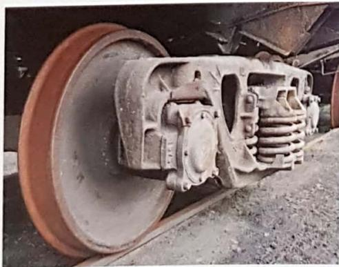
▲ Le grandi molle del carrello ferroviario sono così rigide e pesanti che non si riescono a comprimere o allungare con le mani; tuttavia, ne sono necessarie quattro per attenuare le vibrazioni di una carrozza.
