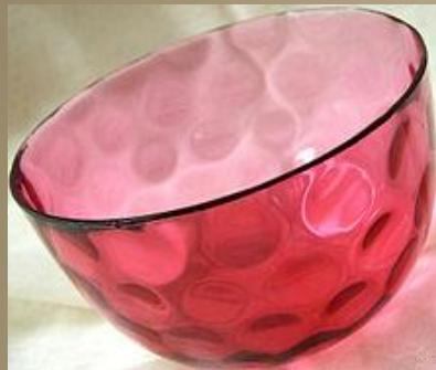
Si tratta di una dispersione di nano particelle di oro in una matrice solida di vetri di silice.
