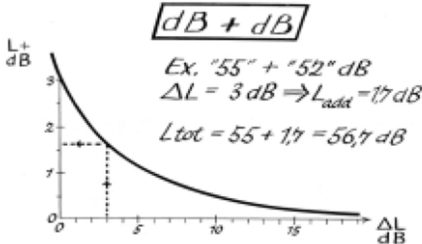
Il grafico a fianco fornisce un metodo di calcolo rapido basato su una curva di incremento del livello più elevato in funzione della differenza di livello delle due sorgenti.
