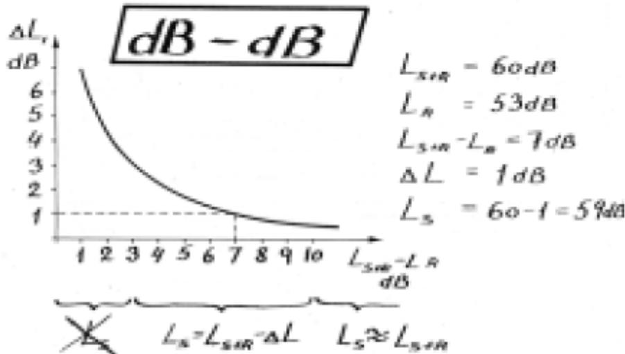
Il grafico a fianco fornisce un metodo di calcolo rapido basato su una curva di decremento del livello più elevato in funzione della differenza di livello delle due sorgenti.
