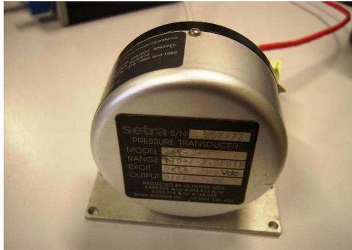
Figura 5 - Trasduttore di pressione differenziale Setra
