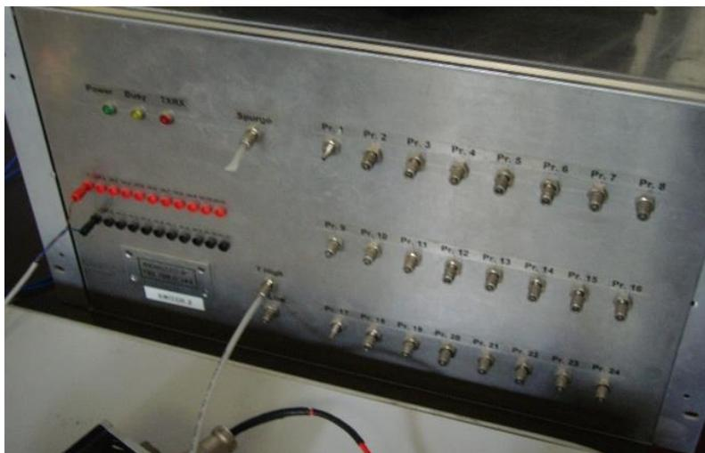
Figura 4 - Switch di pressione realizzato dal Dipartimento di Energetica
