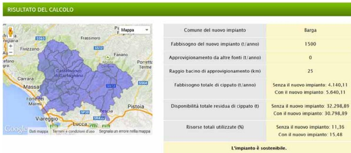
Figura 7.3. Esempio di risultato conseguito con l’interrogazione del sistema di supporto decisionale DSS per la pianificazione di nuovi impianti. La simulazione si basa su una richiesta di fattibilità (in termini di disponibilità di biomasse) di un nuovo impianto, localizzato nel comune di Barga, che ha un consumo annuo di 1500 t di cippato. Nello stesso bacino ci sono impianti che già consumano 4.140 t di cippato.
