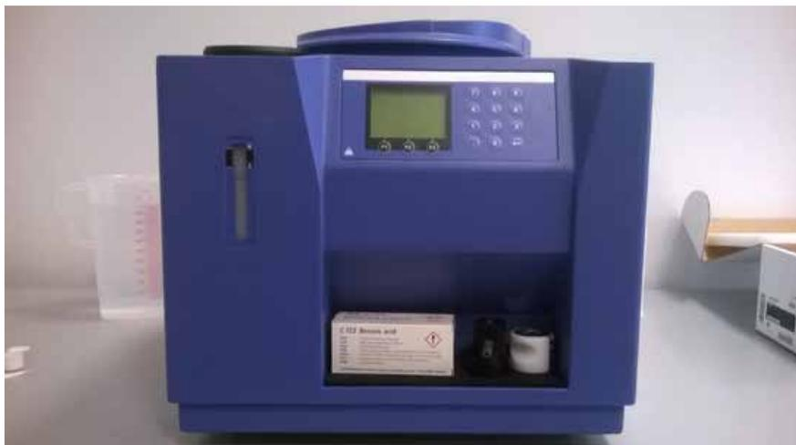
Figura 7.9. Definizione del potere calorifico (UNI EN 14918).
