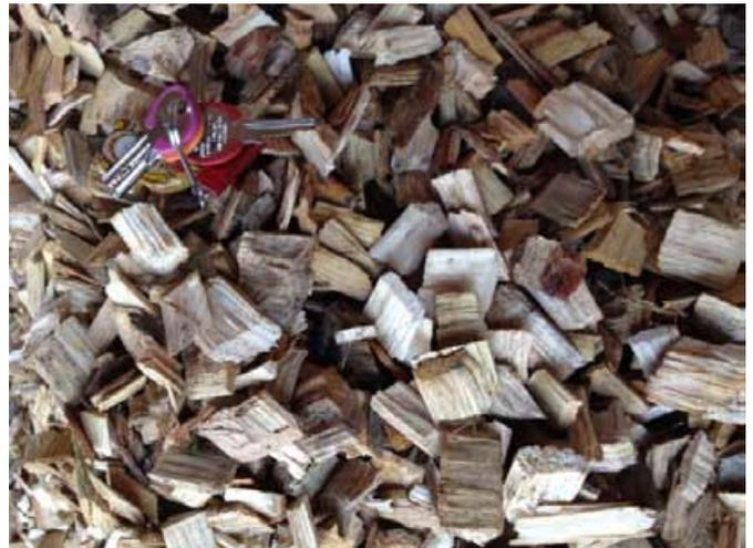
Figura 2.11. Cippato per l'impiego in impianti di teleriscaldamento di medio-piccole dimensioni (esempio di cippato A2).
