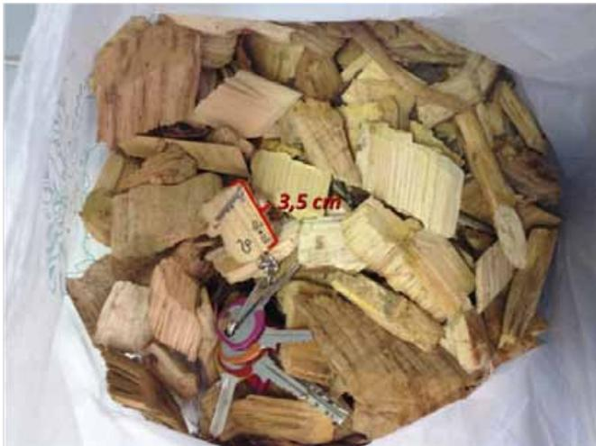
Figura 2.10. Cippato di elevata qualità per l'impiego in impianti di cogenerazione a gassificazione (esempio cippato A1 per gassificatori. Cippato di tipo P50 M $\leq$ 25).
