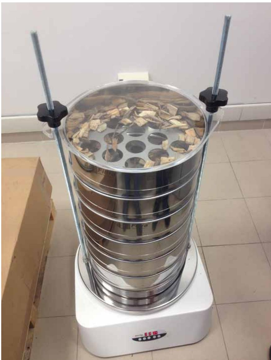
Figura 7.10. Definizione della classe granulometrica (UNI EN 15149-1).
