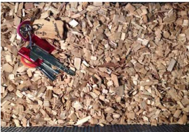
Figura 2.12. Cippato di elevata qualità, il c.d. cippatino per l'impiego in caldaie domestiche.
