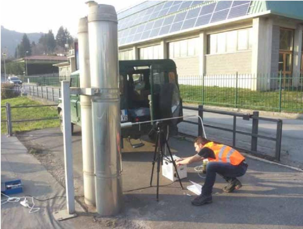
Figura 5.9. Misurazione con impattore mutistadio c/o centrale termica di San Romano in Garfagnana.
