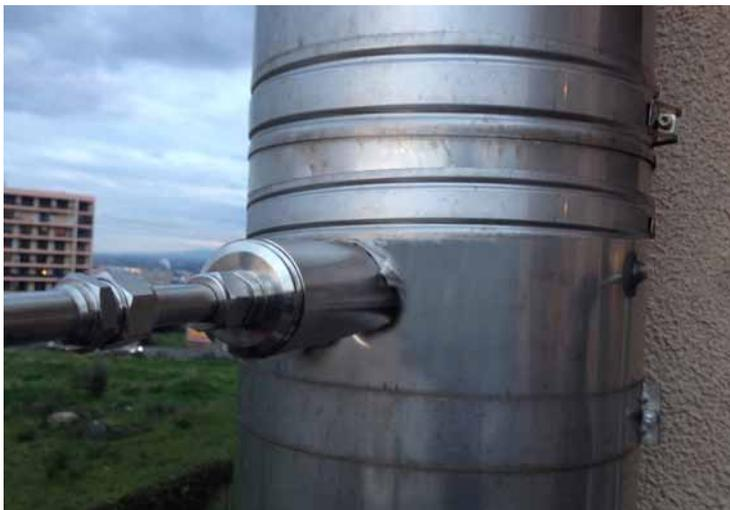
Figura 7.11. Campionamento delle polveri al camino (UNI EN 13284-1).
