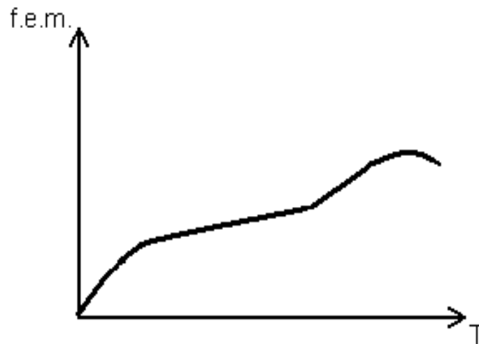
Caratteristica statica di una termocoppia
