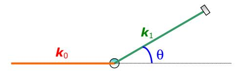
La sonda scambia, in generale, sia energia che impulso con il campione.
