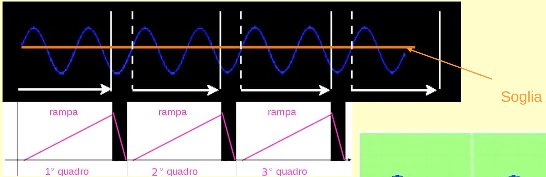
La scansione successiva inizia solo quando il segnale attraversa la tensione di soglia. In questa situazione si dice che il trigger è **agganciato** al segnale, o che il segnale è **triggerato** e si riesce ad avere una figura stabile sullo schermo
