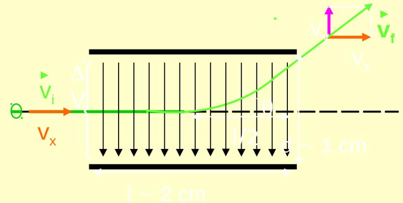
In base al II principio della dinamica, la carica subisce un'accelerazione data da:
