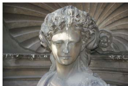
Fig. 6: Esempi di fenomeni di erosione e annerimento (*Foto di proprietà della dott.ssa M. Laurenzi Tabasso).
