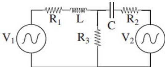
3. Il circuito in figura è alimentato da due generatori sinusoidali  $V_1(t) = V_{10} \cos \omega t$  e  $V_2(t) = V_{20} \cos(\omega t + \varphi)$ . Si determini l'espressione della corrente  $i(t)$  che attraversa la resistenza  $R_3$  e se ne calcolino i parametri con i valori dati. Facoltativamente si determinino poi i valori di  $\varphi$  e del rapporto  $\alpha = V_{20}/V_{10}$  per cui la corrente  $i(t)$  risulta identicamente nulla.
