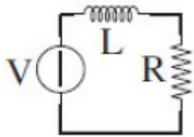
3. Il generatore che alimenta il circuito produce una tensione periodica data dall'espressione  $V(t) = V_0 \sin^2 \omega t$ . Si calcoli la potenza media dissipata sulla resistenza  $R$ . Si ricordi che il formalismo delle impedenze complesse può essere utilizzato solo quando tensioni e correnti sono rigorosamente sinusoidali.
