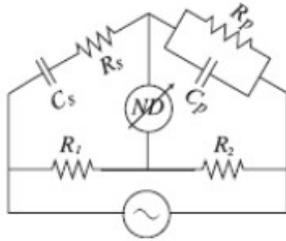
A. Nel *ponte di Wien* in figura, in cui sono noti gli elementi  $R_1$ ,  $R_2$ ,  $R_s$ ,  $C_s$  e la frequenza  $\nu$  del generatore, si determinino i valori di  $R_p$  e  $C_p$  per cui si ha l'azzeramento.
