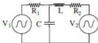
3. I generatori sinusoidali del circuito in figura producono due tensioni pari a  $V_1(t) = V_{10} \cos(\omega t)$ ,  $V_2(t) = V_{20} \cos(\omega t + \varphi)$ , rispettivamente. Si determinino i valori di  $V_{20}$  e  $\varphi$  per cui la massima energia immagazzinata nel condensatore  $C$  risulta più piccola possibile. Si calcoli poi il valore della stessa potenza quando  $V_{20} = V_{10}$  e  $\varphi = \pi/4$ .
