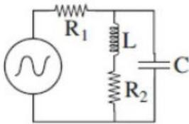
**3.** Il circuito in figura è alimentato da un generatore sinusoidale di tensione  $V(t) = V_0 \cos \omega t$ . Si calcolino la potenza media  $W$  dissipata sulla resistenza  $R_2$  e l'energia massima immagazzinata nel condensatore  $C$ .
