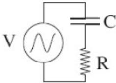
**A.** Un generatore di tensione alternata  $V(t) = V_0 \cos \omega t$  viene chiuso sulla serie di una resistenza  $R$  e un condensatore  $C$ . Si calcoli la potenza media  $\bar{W}$  erogata dal generatore.
