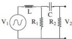
3. Si determini il coefficiente complesso  $\mathcal{A}(\omega) = V_2/V_1$ , rapporto fra la tensione in uscita dal gruppo di impedenze e quella erogata dal generatore, considerate nel formalismo complesso. Si determini quindi il valore  $\omega_M$  di  $\omega$  per cui  $|\mathcal{A}(\omega)|$  risulta massimo e si calcolino modulo e fase di  $\mathcal{A}(\omega_M)$ .
