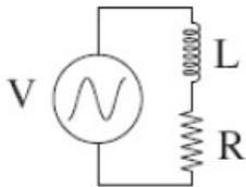
A. Un generatore di tensione alternata  $V(t) = V_0 \cos \omega t$  viene chiuso sulla serie di una resistenza  $R$  e un'induttanza  $L$ . Si calcoli la potenza media  $\overline{W}$  erogata dal generatore. Dati numerici:  $V_0 = 10 \text{ V}$ ,  $\omega = 2\pi \cdot 50 \text{ rad} \cdot \text{s}^{-1}$ ,  $R = 10 \Omega$ ,  $L = 100 \text{ mH}$ .
