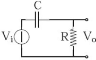
1. Un generatore ideale di tensione produce ai suoi capi una d.d.p. variabile secondo l'espressione:  $V_i(t) = V_{i0} \sin^2(\omega_1 t)$ . Il segnale viene passato attraverso un filtro passa-alto formato da un condensatore  $C$  e una resistenza  $R$ . Si determini l'espressione della differenza di potenziale all'uscita del filtro, calcolando i valori dei parametri.
