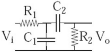
3. Si determini l'espressione della funzione di trasmissione complessa  $\mathcal{A}$  del filtro in figura, in funzione dei componenti. Si calcolino poi: il valore della frequenza  $\nu$  per cui  $|\mathcal{A}|$  risulta massimo e il corrispondente valore di  $|\mathcal{A}|_{[\text{dB}]}$ , nonché i valori di frequenza per cui  $|\mathcal{A}|$  scende di 3 dB, ossia di un fattore  $\sqrt{2}$ , rispetto al valore massimo.
