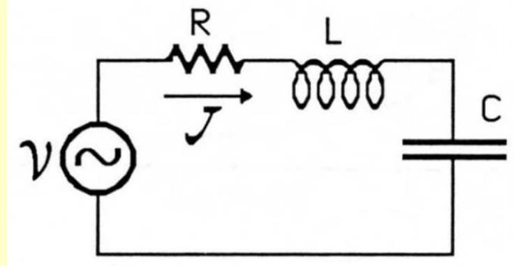
per  $\omega \rightarrow 0$   $|Z| \rightarrow \infty$  (condensatore)  $\varphi_Z \rightarrow -\pi/2$
