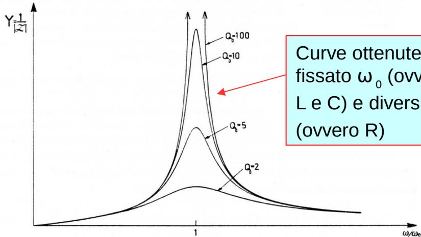
Curve ottenute per fissato  $\omega_0$  (ovvero L e C) e diversi  $Q_0$  (ovvero R)
