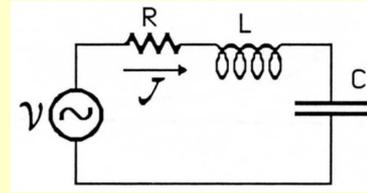
$$Q = 2\pi \frac{\text{Energia massima immagazzinata}}{\text{Energia dissipata nel sistema durante un ciclo}} = 2\pi \frac{E_{max}}{\langle E_D \rangle}$$
