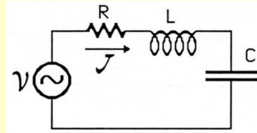
Per  $\omega = \omega_0 \rightarrow J = V_0 / R$  massima  $\rightarrow V_R, V_C$  e  $V_L$  massime  $\rightarrow V_R = J R \rightarrow V_C = -V_L$
