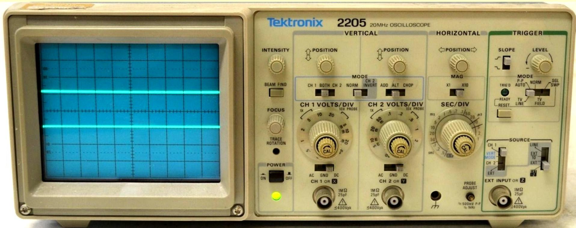
L'oscilloscopio visualizza l'andamento di un segnale elettrico nel tempo: dato un certo segnale di tensione in ingresso, consente misure qualitative e quantitative di: differenza di potenziale e di intervalli di tempo (es. *periodo di oscillazione del segnale in ingresso*).
