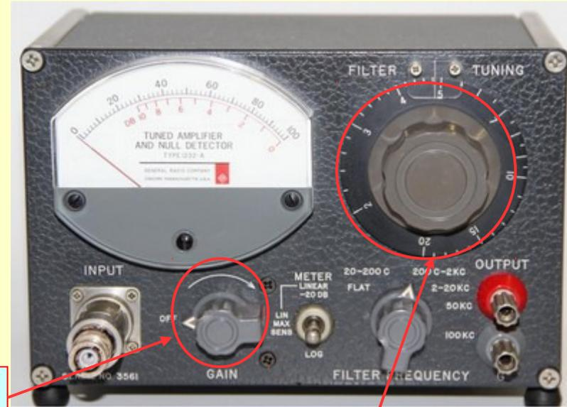
In condizioni di non equilibrio massimizzare l'indicazione dello strumento agendo sulla manopola "sintonia" (tuning)
