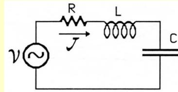
Per  $\omega = \omega_0 = 1/\sqrt{LC} \rightarrow J = V_0 / R$  massima  $\rightarrow V_R, V_C$  e  $V_L$  massime  $\rightarrow V_R = J R \rightarrow V_C = -V_L$  infatti
