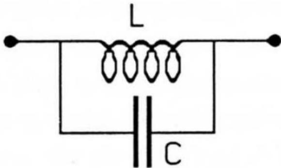
Circuito equivalente con  $C$  capacità tra H e scatola ( $G=L$ ) + capacità distribuita su avvolgimento
