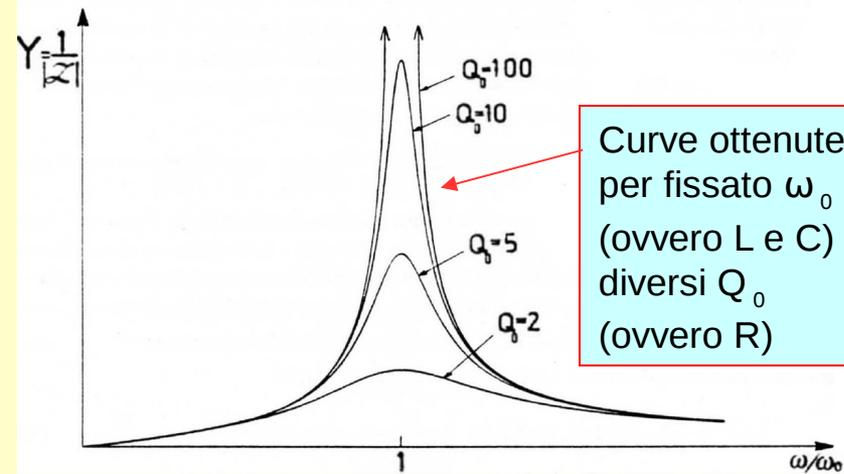
Curve ottenute per fissato  $\omega_0$  (ovvero L e C) e diversi  $Q_0$  (ovvero R)
