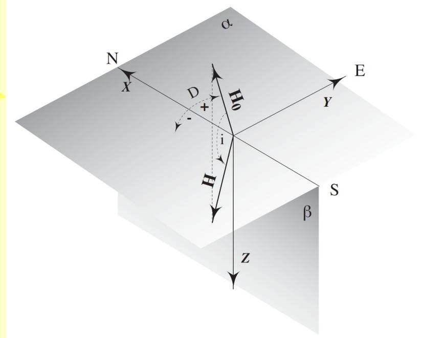
Nel sistema di riferimento mostrato, il campo magnetico terrestre è caratterizzato dalle componenti  $B_X (= B_{\text{NORD}})$ ,  $B_Y (= B_{\text{EST}})$  e  $B_Z$  (verticale discendente)
